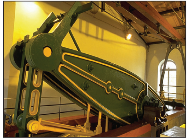
Le balancier et le parallélogramme de Watt
